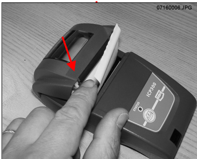
Obrázek 4. Uzavření krytu prostoru pro papír.
