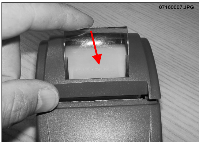
Obrázek 3. Uvolnění krytu prostoru pro papír.
